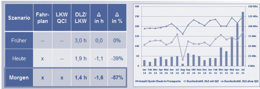
Abbildung 3.5: Vergleich der durchschnittlichen Lkw-Durchlaufzeit bei Fahrplanrelationen mit und ohne Lkw-Quick-Check-In (Roth 2019:362)
