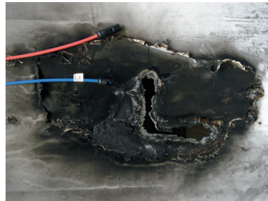
Abb 4.8.13: Lichtbogenschaden am PV-Modul, Quelle: VGH Versicherungen
