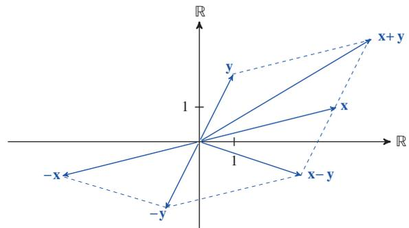
Abb. 7.3: Geometrische Veranschaulichung der Addition und skalaren Multiplikation zweier Vektoren  $\mathbf{x} = (4, 1)^T$  und  $\mathbf{y} = (1, 2)^T$  in der euklidischen Ebene  $\mathbb{R}^2$
