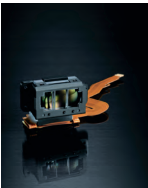
⌆ Das Autofokusmodul Multi- CAM 3500FX (Bild: Nikon)
