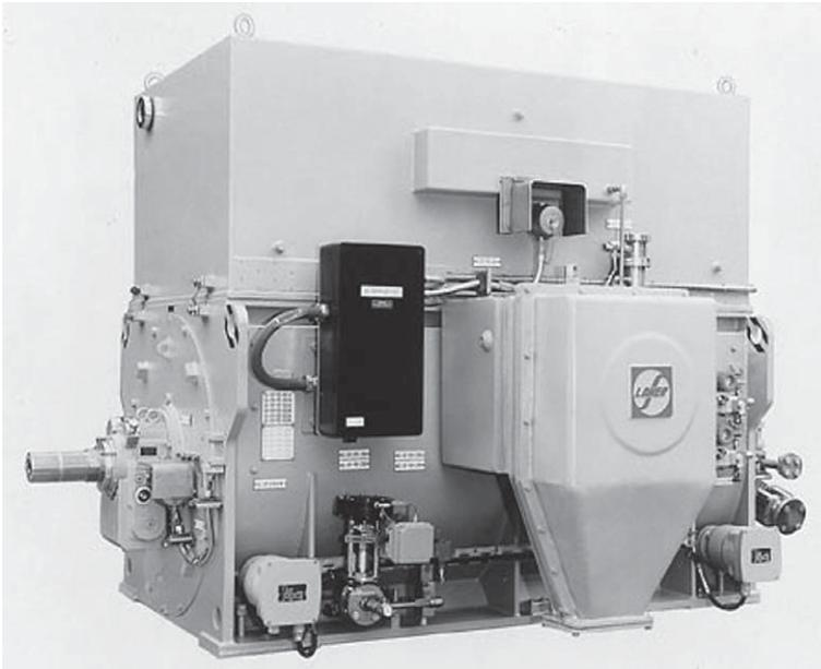
**Bild 5.2** Ausführungsbeispiel eines Drehstrom-Käfigläufermotors für Hochspannung in Zündschutzart Ex bei II T3, 1 600 kW; 6 kV; 60 Hz; 3 600 min<sup>-1</sup>, Kühllart IC 81W mit aufgebautem Luft-Wasser-Wärmetauscher
