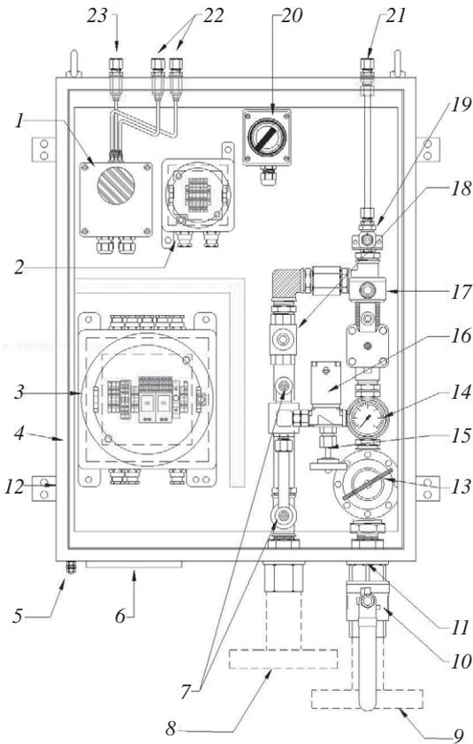
**Bild 5.3** Innenansicht eines am Motor angebauten Steuergeräts (Ausführungsbeispiel).
