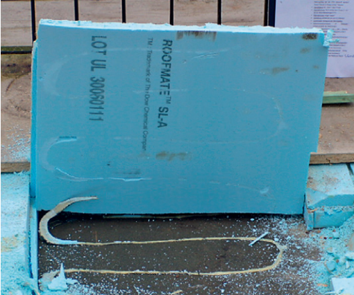
Abb. 10.4: Hier ist weder eine ausreichende Verbindung des PUR-Klebers mit dem Untergrund noch mit der Dämmplatte gegeben.
