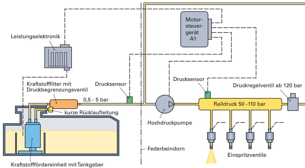
Der Motor wird durch eine bedarfsgeregelte Kraftstoffpumpe mit Benzin versorgt. Durch die Bedarfsregelung kann der Energiebedarf der Kraftstoffpumpe reduziert und somit Kraftstoff eingespart werden. Dabei stellt die Kraftstoffpumpe nur die vom Motor benötigte Kraftstoffmenge unter Einregelung eines durch Kennfelder vorgeschriebenen Systemdrucks zur Verfügung.
