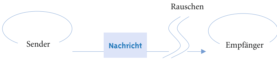
Abbildung 8.1 Ein einfaches Sender-Empfänger-Modell. Vom Sender wird eine Nachricht encodiert über einen Kanal zum Empfänger geschickt, der die Nachricht empfängt und decodiert. Bei der Übertragung der Nachricht vom Sender zum Empfänger kann es zu Störungen („Rauschen“) kommen. Ursache dieses Rauschens sind im übertragenen Sinne technische und damit sachorientierte Probleme, etwa, dass die Nachricht zu leise versandt wird oder dass Sender und Empfänger nicht den gleichen Sprachcode sprechen. Zum Teil werden auch psychologische Barrieren berücksichtigt, etwa Wahrnehmungsverzerrungen durch Stereotypenbildung.
