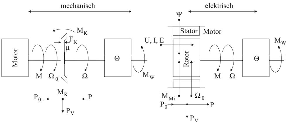
Abb. 2.1: Modelle für Antriebssysteme
