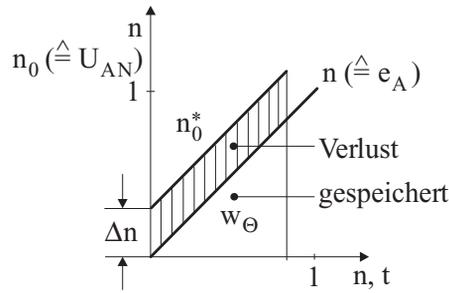
Abb. 2.8: Beispiel: Energiebilanz einer stromgeregelten GNM
