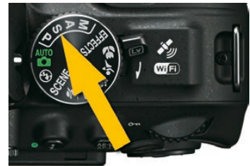
Dieses Symbol kennzeichnet die Blendenautomatik.
