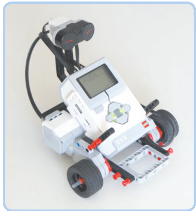
Abbildung 2-1: Der EXPLOR3R bewegt sich mit zwei Vorderrädern und einem Stützrad hinten.
