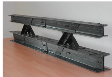
aus vier Einzelsegmenten gefügter Teil einer Linearführung
