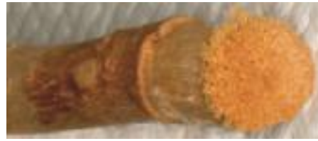
nach Eintauchen in Wasser fächert sich eine Bürste
