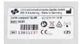
Abb. 1: Auf dem Typenschild elektrischer Geräte ist u. a. die Leistungsangabe in Watt aufgedruckt.
