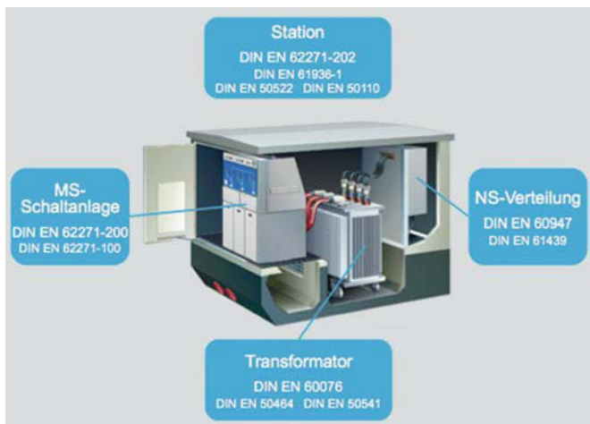
Bild 5.1: Übersicht über elektrotechnische Leitnormen von Stationshauptbauteilen
