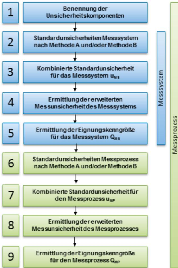
Abb. 3-1: Grobschema der Messunsicherheitsbestimmung
