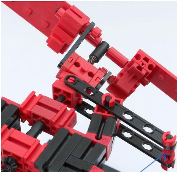
Abb. 16–10 Steuerung des Anstellwinkels der Heckrotorblätter (Pitch)
