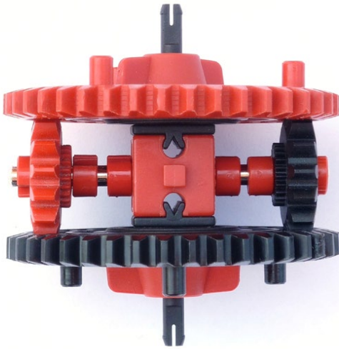
Abb. 3-10 Differenzialgetriebe mit freilaufenden Kronenzahnrädern
