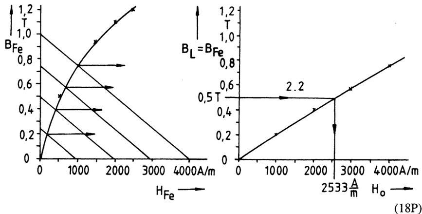
Zu 2.2 Bei  $B_L = 0,5 \text{ T}$  wird abgelesen (s. Diagramm):  $H_0 = 2533 \text{ A/m}$ .
