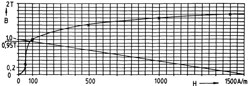
Zu 4.2 Energie im Luftspalt mit  $\mu = \mu_0$  (Bd.1, S.347, Gl.3.387 oder FS S.82: linearer Verlauf)
