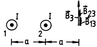
Berechnung von  $B_2$ , wenn die Leiter 1 und 3 stromdurchflossen sind:  $\vec{B}_2 = \vec{B}_{12} + \vec{B}_{32} = 0$
