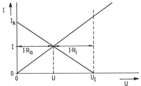
Aus den überlagerten Kennlinien lassen sich die Spannungen am Außenwiderstand und Innenwiderstand abgreifen.
