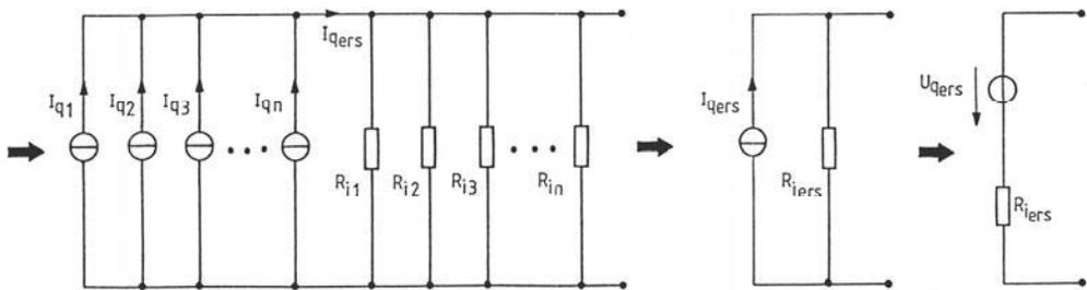
Überführung von n parallel geschalteten Stromquellen in eine Ersatz-Stromquelle und eine Ersatz-Spannungsquelle
