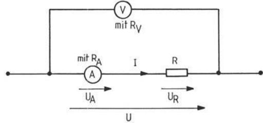
*Spannungsrichtige Messschaltung zur Messung von kleinen Widerständen:*
