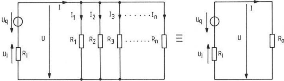
Ersatzschaltung eines Stromkreises mit n parallel geschalteten ohmschen Widerständen
