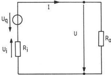
Wirkungsgrad des Grundstromkreises mit Ersatzstromquelle
