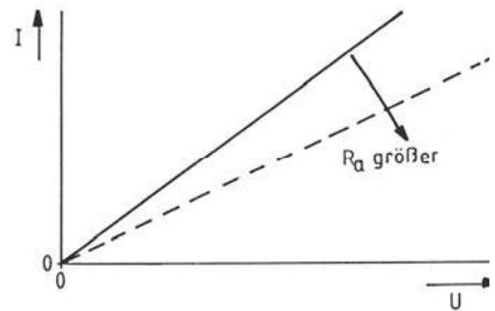
Überlagerung der Kennlinien des aktiven und passiven Zweipols
