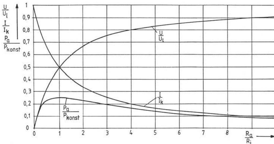
Spannung, Strom und Leistung in Abhängigkeit von den Widerständen im Grundstromkreis
