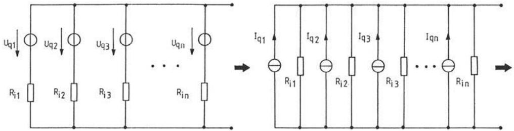
Überführung von n parallel geschalteten Spannungsquellen in n äquivalente Stromquellen
