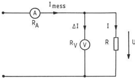
Spannungsrichtige Messschaltung mit zwei getrennten Instrumenten
