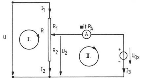
Im Zustand der Kompensation ist der Spannungsteiler unbelastet, denn der Belastungsstrom  $I_3$  ist Null. Die unbekannte Spannung ergibt sich dann aus
