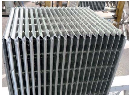
Abb. 2.2 und 2.3 Ein Kreuzstromwärmeübertrager in einem kompakten RLT-Gerät (Quelle: Swegon GmbH) und Detailsicht bei der Produktion eines Kreuzstromwärmeübertragers (Quelle: M. Stahl)
