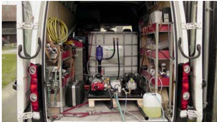
Abb. 3.4.22/4: Versorgungperipherie im Transporter (Quelle: B & W Solar Solutions)
