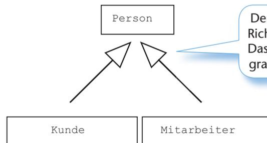
Der Pfeil zeigt immer in Richtung der Basisklasse. Das ist eine UML-Klassendiagramm-Konvention.
