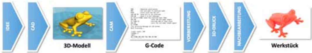
Abb. 1-11 Druckprozess von der Idee zum fertigen Werkstück
