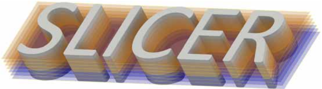
Abb. 1–7 Zerlegung eines 3D-Objekts (Schriftzug) in Scheiben
