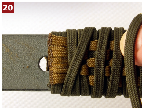
Wenn Sie das Ende erreicht haben, wickeln Sie das Arbeitsseil einige Male um den Griff, damit das Festhalten bequemer wird.
