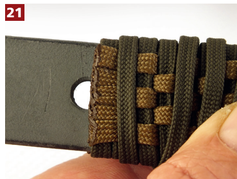
Schneiden Sie die Enden der Webseile glatt ab und schmelzen Sie sie an, um ein Aufdröseln zu vermeiden.
