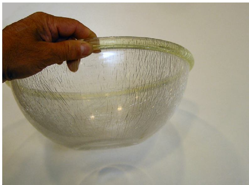
Bild 3.26 Polycarbonat hat eine geringe chemische Beständigkeit, wie an diesen durch Essig verursachten Rissen in einer Salatschüssel zu erkennen ist.
