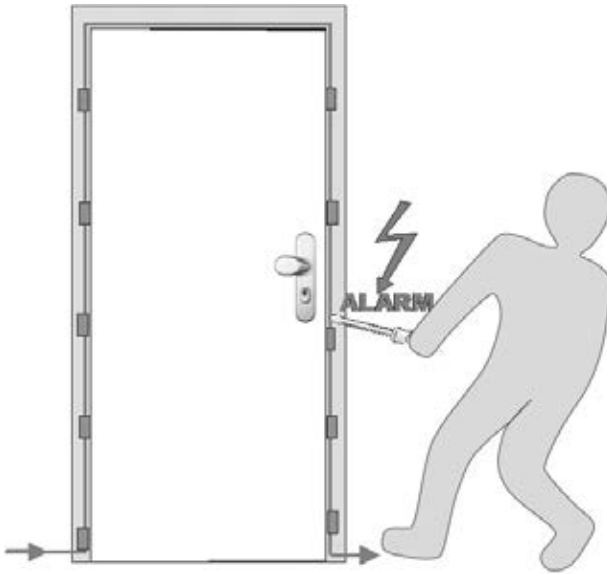
Bild 13: Gleichgültig wo ein Täter ansetzt, es wird bereits beim ersten Angriffsmelder Alarm ausgelöst [Matouschek]
