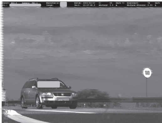
Abbildung 30 – Fotolinie: schlecht auszuwertende Perspektive durch zu niedrig positionierte Kamera
