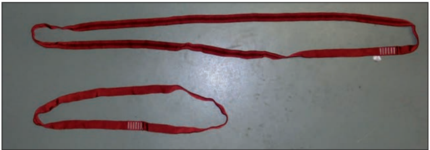
Abbildung 8: Bandschlingen nach EN 354 und EN 795B als Anschlagmittel (Foto: Werft)
