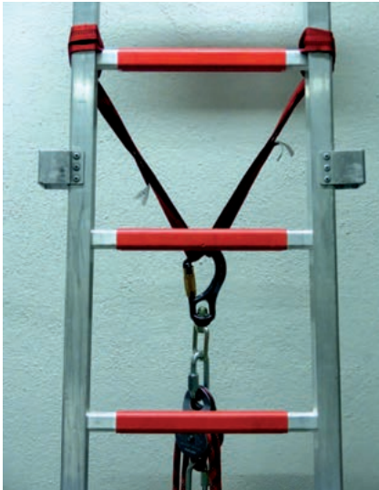
Abbildung 29: Anschlag der Leiterholme mit Bandschlingen mittels Ankerstich (Foto: Werft)
