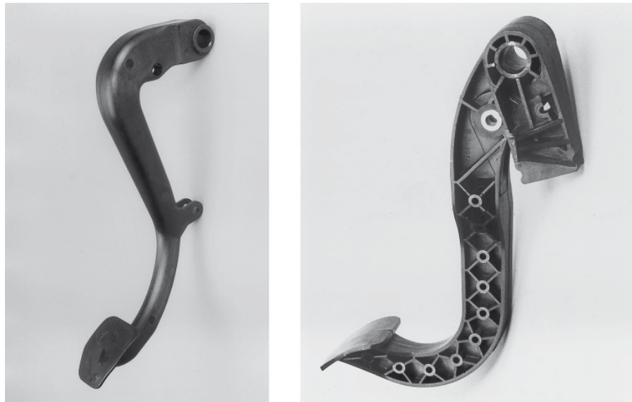
Bild 4.18: Kupplungspedal mit geschlossenem Hohlprofil (links) (BMW) und verripptem Doppel-T-Profilquerschnitt aus PA 66-GF (rechts) (Mercedes-Benz/BASF)
