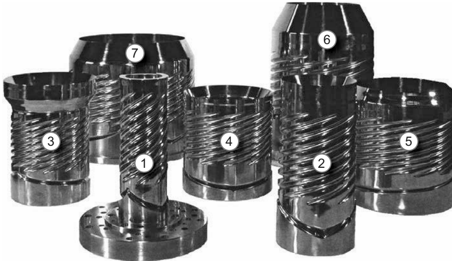
Bild 7.15 Grundkörper eines Wendelverteilers für die 7-Schicht-Coextrusion
