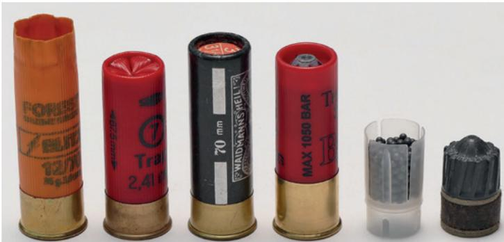
**Abbildung 7:** Schrotpatronen – v.l.n.r.: abgeschossene Patrone (erkennbar die offene Börde-lung). Patronen mit der Angabe der Hülsenlänge 67,5 mm und 70 mm. Patrone mit Flinten-laufgeschoss und max. Gasdruckangabe. Schrote mit Schrotbeutel aus Plastik (damit wird eine Berührung der Schrote mit dem Lauf vermieden, somit keine Verformung der Schrote, bessere Abdichtung im Lauf und auch gleichmäßigere Streuung der Schrote). Flintenlaufgeschoss Kal. 12 (Fabrikat Brenneke).
