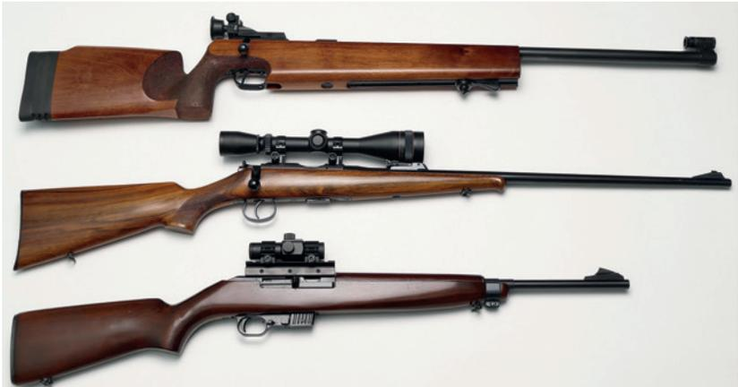
**Abbildung 2:** Kleinkalibergewehre (alle Kaliber .22 long rifle oder .22 lfb): von oben: 1) Wettkampfbüchse, Fa. Walther für sportliches Schießen auf 50 m (Einzellader) mit sogenannter Diopter-Visierung. 2) Jagdbüchse für Kleinwild, Brünner Waffenwerke, Mod. 2 (Mehrlader) mit Zielfernrohr. 3) Selbstladebüchse, Erma EGMI, Mod. 70 mit Rotpunktvisier.
