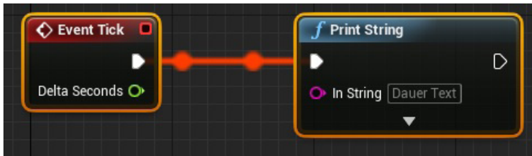
Bild 4.20 So sehen aktive Debug-Stränge aus
