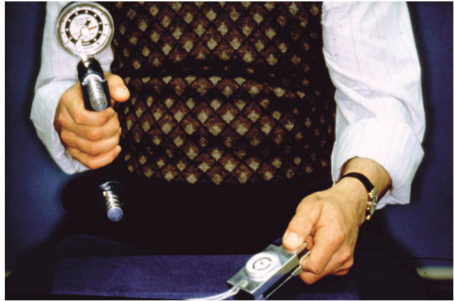
■ Abb. 2.6 Prüfung der Kraft für den Grobgriff mit dem Jamar-Dynamometer (links) und für den Fingerkuppen-Spitzgriff mit dem Pinch-Gauge-Dynamometer (rechts)
