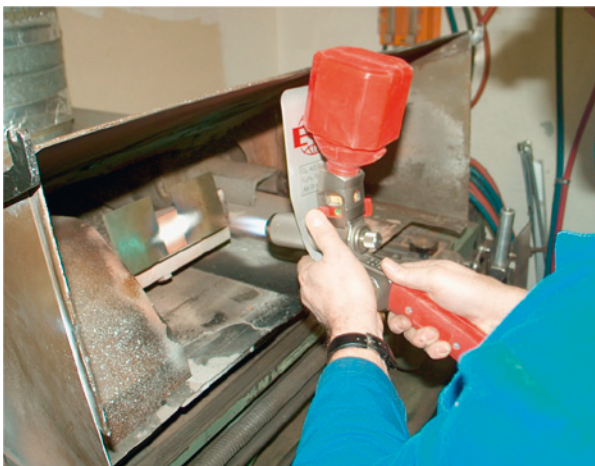
Abb. 4.37: Pulverflammspritzen von Hand
