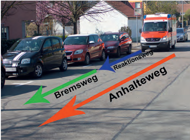
Abb. 53.1 Reaktions- und Bremsweg ergeben den Anhalteweg. [0985]
