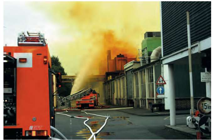
Abb. 15.21 Beispiel für einen Gefahrstoffunfall: Freisetzung von Nitrose-Gasen, nachdem eine Metallplatte in einen 55 000l fassenden Salpetersäurebehälter gefallen war. Die Nitrose-Gase wurden über eine laufende Absauganlage durch das Dach in die Atmosphäre abgeblasen. Es bildete sich eine weithin sichtbare, braun-gelbe, toxische Gaswolke. Ersteintreffende Einsatzkräfte haben sich in Sicherheit gebracht. [O429]
