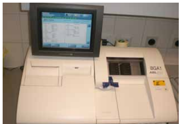
Abb. 1252 BGA-Meßgerät (BGA: Blutgasanalyse; syn.: Astrup [benannt nach dem dänischen Physiologen Poul Børndahl Astrup, 1915-2000])
