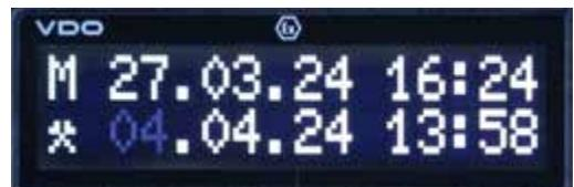
Denn sonst würde in der Anzeige in dem Moment der 30.09. angezeigt werden, obwohl aktuell erst der 8.09. ist. Daher muss nun durch Drücken der OK-Taste der Monat angewählt werden, so dass dieser blinkt und mit den Pfeiltasten verstellt werden kann.
