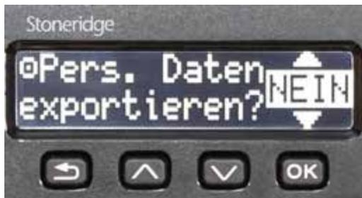
Analog zu VDO wird durch die angezeigte Auswahl der **aktuelle Zustimmungsstatus** dargestellt. Die Ausgabe von Daten wurde also in dem Fall bereits verneint. Ansonsten würde an dieser Stelle JA angezeigt werden.
