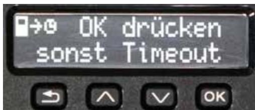
Wird der Timeout jedoch tatsächlich verpasst, so wird bei Stoneridge im Massenspeicher **gar kein Zustimmungsstatus** eingetragen. Ein Telematiksystem, welches auf die personenbezogenen Daten zugreifen soll, müsste ohne einen solchen eindeutigen Status die Übertragung dem Grunde nach abbrechen.
