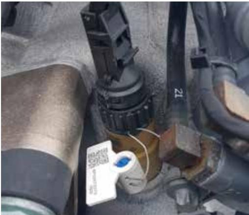
Seit dem **Smart Tacho** wird die Nummer dieser Plombe während der Kalibrierung im Fahrtenschreiber und in einer Datenbank beim Hersteller gespeichert. So ist die Plombe theoretisch rückverfolgbar.
