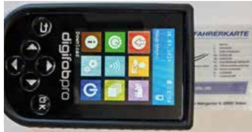
Gleiches gilt für den Downloadkey von VDO. Für den Download des Massenspeichers wird bei diesem kein zusätzliches Kabel benötigt.
