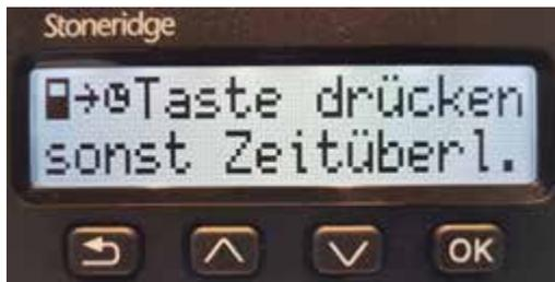
Mit der Unternehmenskarte kann dieser schon annähernd seit den Anfängen des Digitachos auf **20 Minuten** erhöht werden, so dass die Gefahr, durch Ablenkung die Eingabemöglichkeit des Nachtrags zu verpassen, nicht besteht, siehe ► Kapitel 6.9.3.
